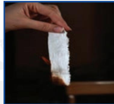
شکل ۳-۴—سوختن پارچه ویسکوز ریون
