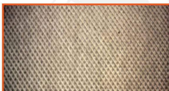
شکل ۱۵-۹-پارچه بی‌بافت تولید شده به روش حرارتی
