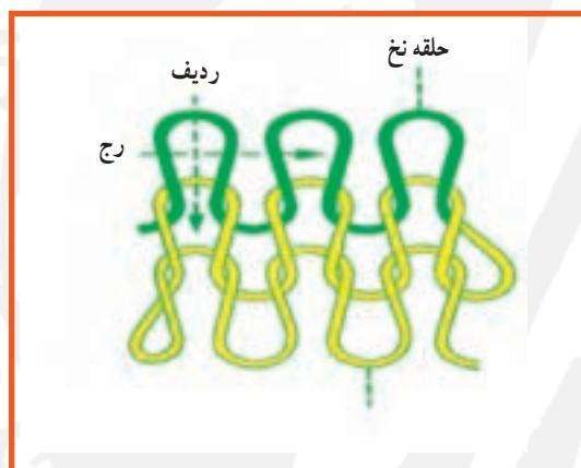
شکل ۸—ساختار پارچه حلقوی پودی
