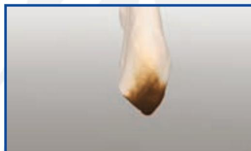
شکل ۲-۹- سوختن پارچه پنبه‌ای
