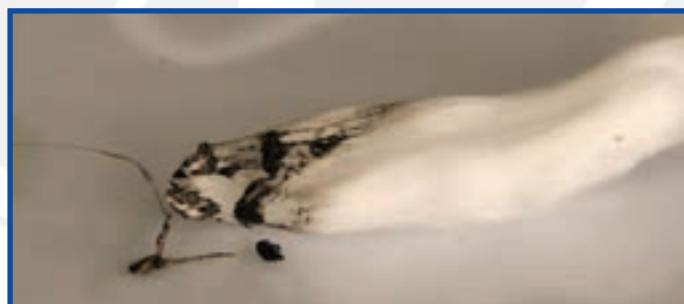
شکل ۱۴-۵- خاکستر حاصل از سوختن الیاف اکریلیک
