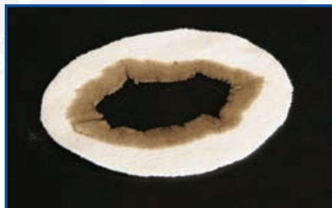
شکل ۲-۱۱- اثر اسید سولفوریک با غلظت ۷۵ درصد بر پارچه پنبه‌ای
