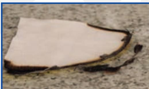
شکل ۲-۱۰- خاکستر حاصل از سوختن پارچه پنبه‌ای
