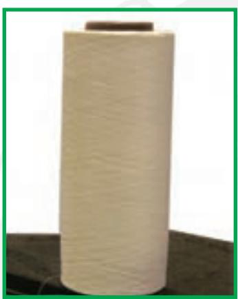
شکل ۸-۱۱—سیگارت (بسته استوانه‌ای)
