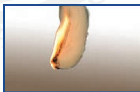
شکل ۳-۶- سوختن الیاف پشم
