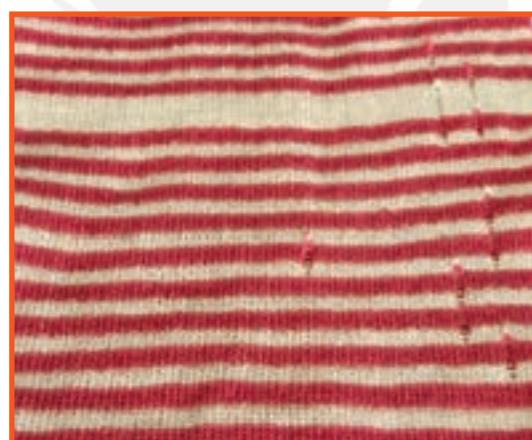
شکل ۹—در رفتن حلقه‌ها و ایجاد سوراخ در پارچه حلقوی پودی
