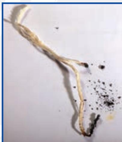
شکل ۳-۱۶- خاکستر حاصل از سوختن الیاف ابریشم
