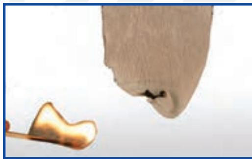
شکل ۵-۸ – سوختن پارچه از جنس پلی استر
