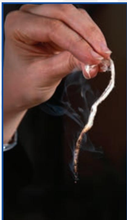
شکل ۳-۱۵- سوختن الیاف ابریشم
