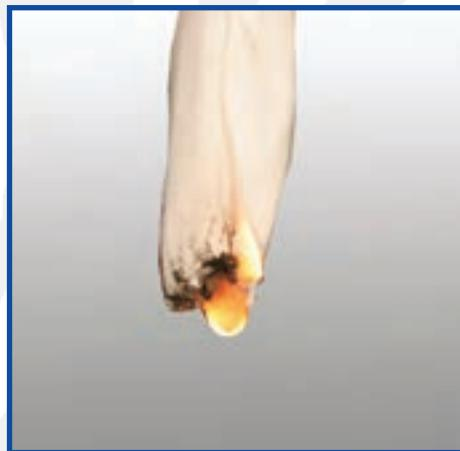
شکل ۱۳-۵- سوختن الیاف اکریلیک
