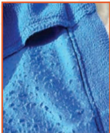
شکل ۹-۱- پرزدانه در سطح پارچه
