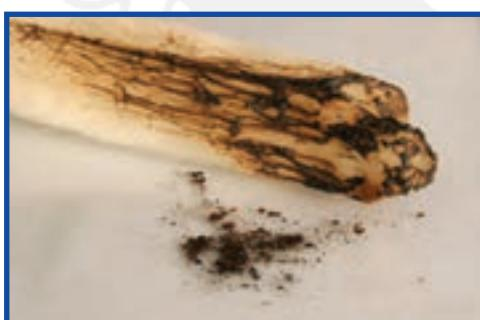
شکل ۳-۷- خاکستر حاصل از سوختن الیاف پشم
