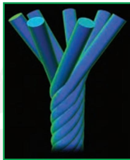
شکل ۶-۸- نحوه تاییدن الیاف به دور یکدیگر
