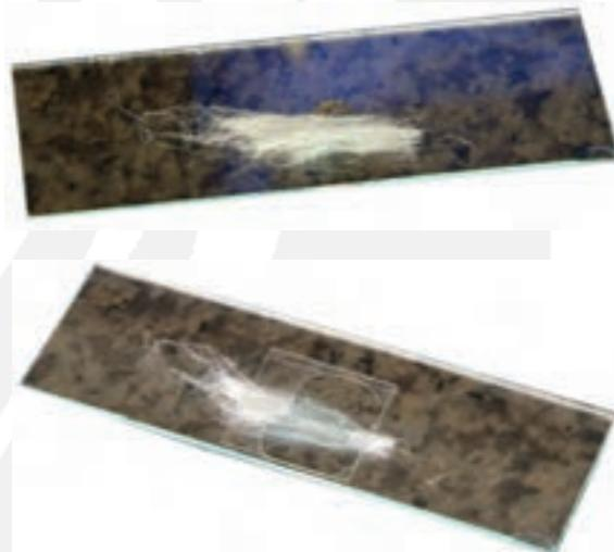
شکل ۱-۵- تهیه سطح مقطع طولی الیاف
