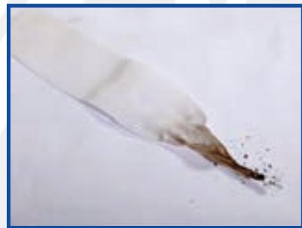
شکل ۴-۹ خاکستر حاصل از سوختن پارچه استات
