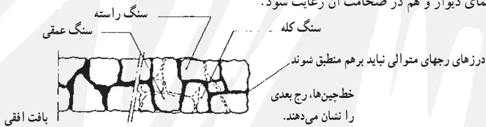
شکل ۲-۲۳—ترتیب قرار گرفتن رجهای را به دقت ملاحظه کنید. رجهای قائم اگر در یک امتداد قرار گیرند از یکپارچگی دیوار کاسته می‌شود.
