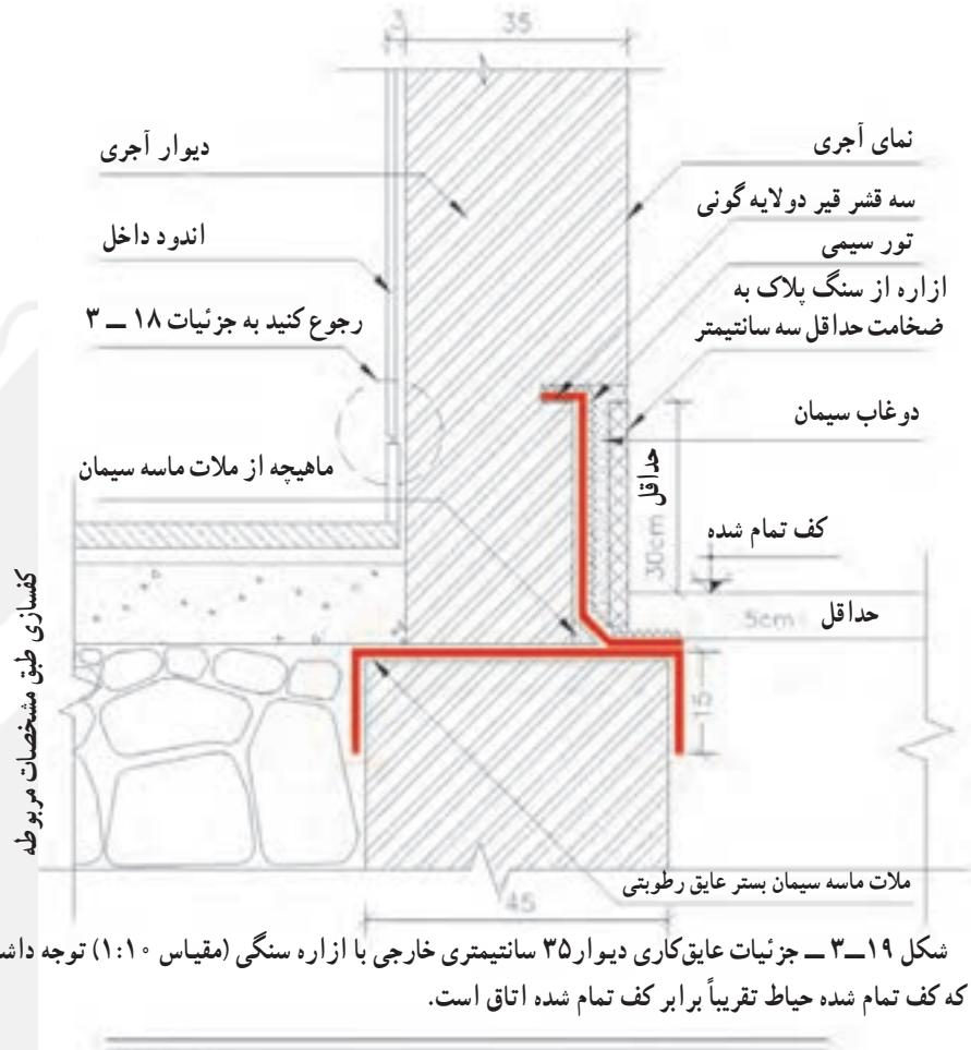
شکل ۱۹-۳- جزئیات عایق کاری دیوار خارجی با ازاره سنگی (مقیاس ۱:۱۰) توجه داشته باشید که کف تمام شده حیاط تقریباً برابر کف تمام شده اتاق است.
