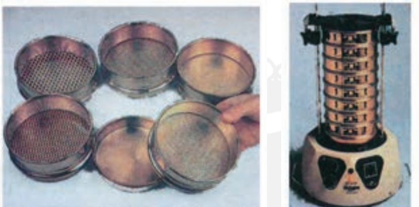
شکل ۲-۱۱- شیکر (Shaker) برای سرنند کردن دانه‌ها (تصویر سمت راست) انواع الک با شماره‌های مختلف (تصویر سمت چپ)
