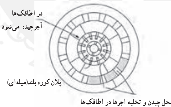
شکل ۶-۶- کوره های هوفمان حلقه ای و حلقه ای کشیده
