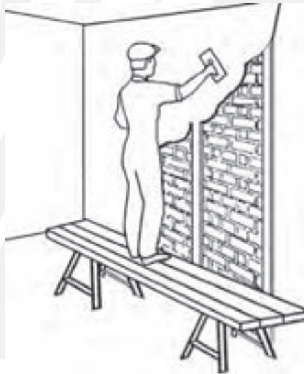
شکل ۵-۸- طریقه‌ی گچ کاری دیوار
