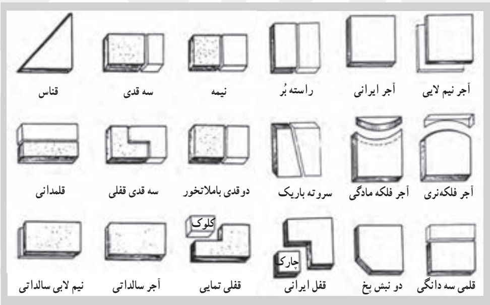
۱۳-۶- اجزای آجر و انواع تراش‌های روی آن
