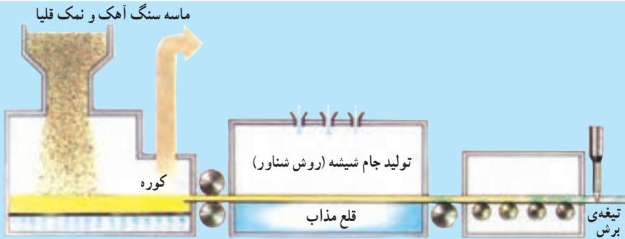
تصویر شماتیک کوره‌ی ذوب شیشه و تولید شیشه‌ی جام به روش قلع مذاب
