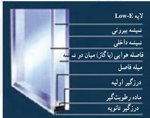
شکل ۴-۱۲- کاربرد شیشه در پنجره‌های دوجداره و تصاویری از شیشه جام لایه‌دار و بلوک شیشه‌ای
