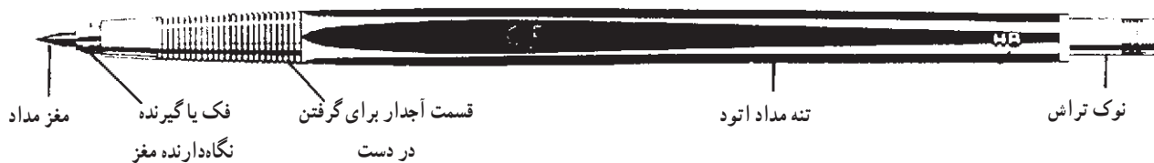
شکل ۷- مداد اتود و قسمت های مختلف آن
